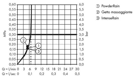
I valori di consumo sono stati misurati nella pratica con le armature appartenenti (Termostato/Miscelatore/Valvola sotto-intonaco).
